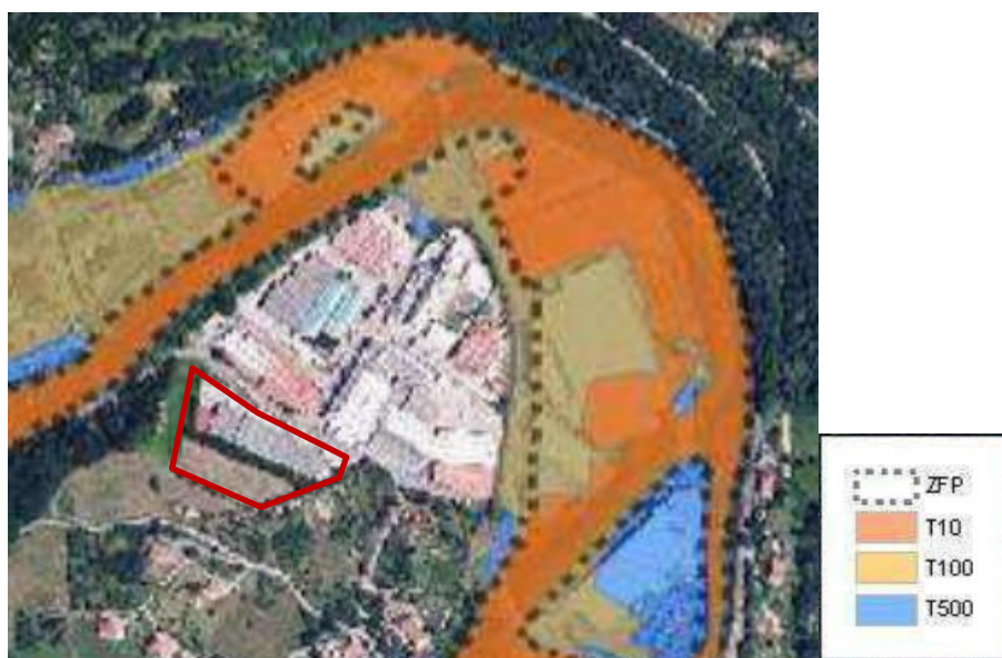
Figura 16. Delimitación de zonas inundables del ARPSI Río Urumea ES017-GIP-17-1. En rojo, parcela objeto del Estudio de Detalle. Fuente Plan de gestión del riesgo de inundación 2015-2021.
